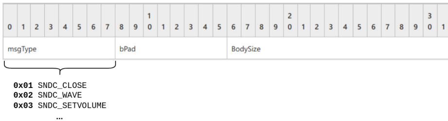
Fig. 5. SNDPROLOG header of an RDPSND PDU.
