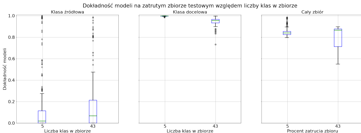
Rysunek 4.19: Wykres przedstawiający dokładność zatrutych sieci mierzoną na zatrutej klasie źródłowej, zatrutej klasie docelowej oraz na całym zatrutym zbiorze testowym, względem liczby klas w zbiorze.
