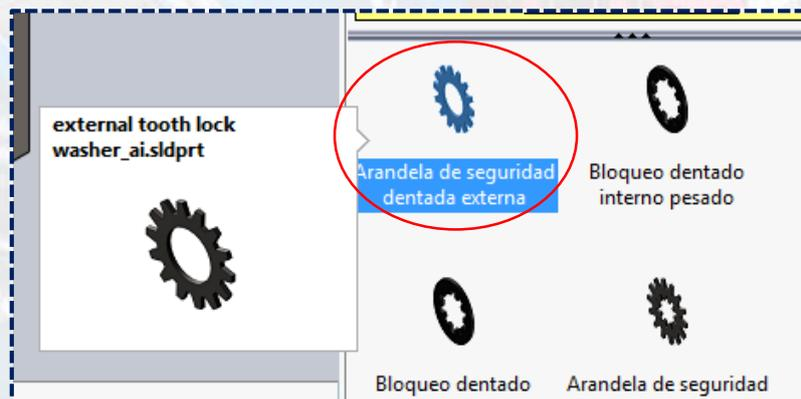
**Solidworks** detecta automáticamente el tamaño y fija la arandela **concéntrica** en el taladro; asimismo, crea la **relación de posición coincidente** en la cara seleccionada luego de **aceptar**.
