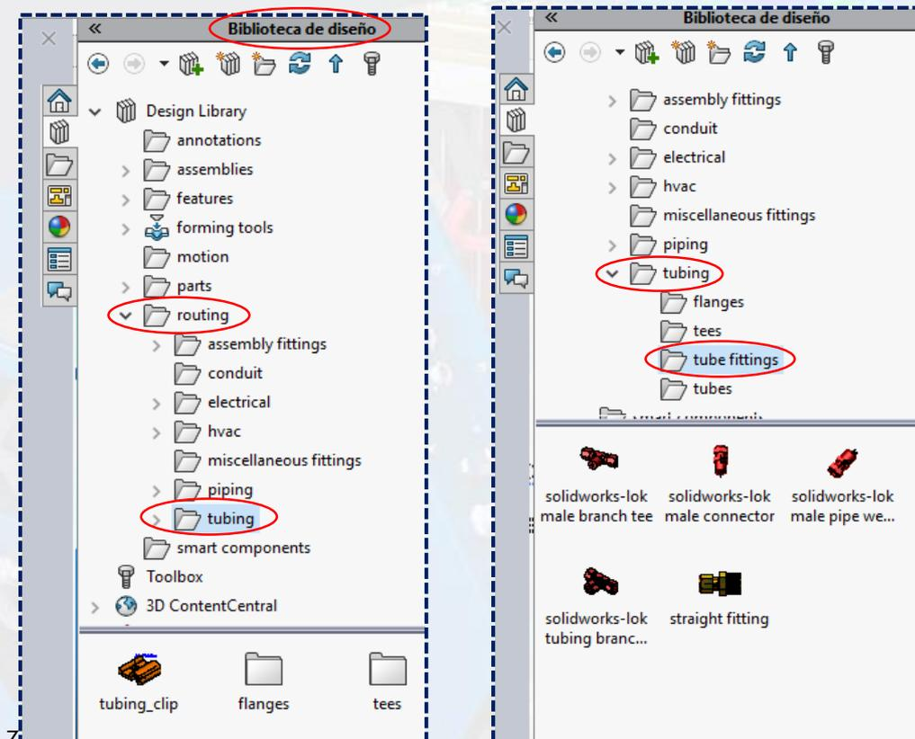
A continuación, seleccionar la conexión **straight fitting**, arrastrar y posicionar en la cavidad de la chapa.
