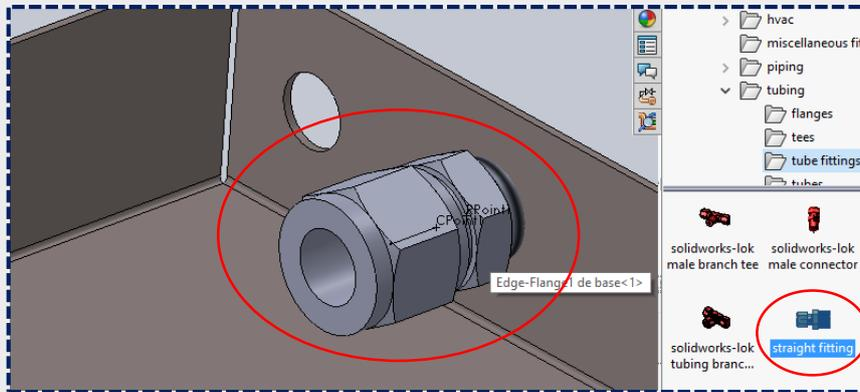
Después, elegir la **configuración** que viene por defecto (**.50 tube x .38 NPT**) y dar **aceptar**.
