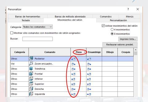
Luego, seleccionar en la columna **Comando** a **Nuevo** y desplegar en la fila **Pieza**.
