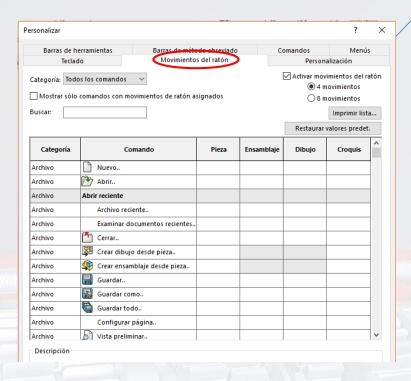
Se abrirá una serie de comando que se le podrá agregar, por lo que se debe seleccionar 8 movimientos en Activar movimientos de ratón.
