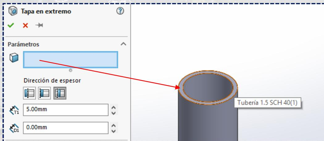
Seleccionar el tercer ícono (**interna**) en **Dirección de espesor** y colocar el valor de **5**; de ahí, dar **aceptar**.
