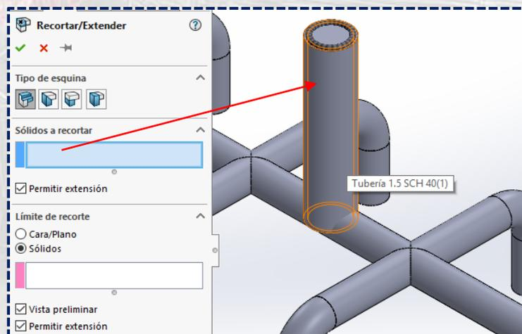
Y luego la tubería inferior en **Límite de corte**.
