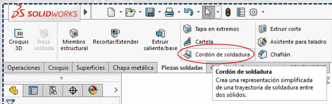
Seleccionar la curva interna de la tubería y luego la curva externa de la tapa.
