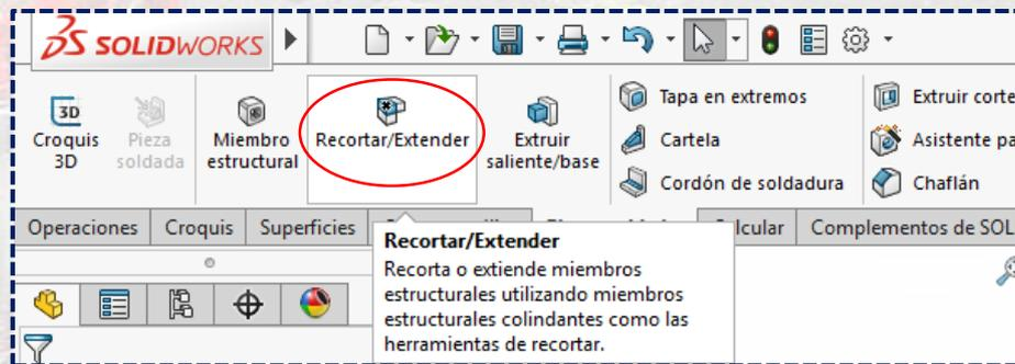
Dar clic en la tubería vertical central en **Sólidos a recortar**.
