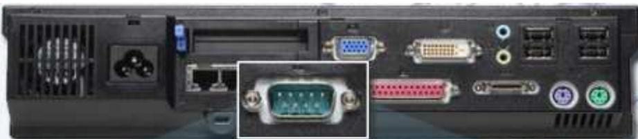
El puerto serial es un socket que se utiliza para conectar un dispositivo, como un mouse o un puntero de bola.
