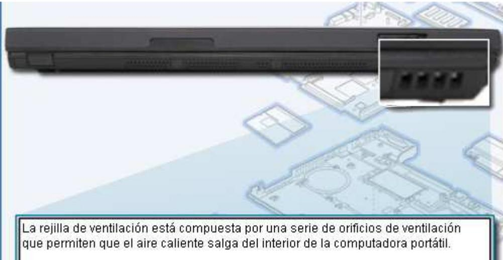
La rejilla de ventilación está compuesta por una serie de orificios de ventilación que permiten que el aire caliente salga del interior de la computadora portátil.
