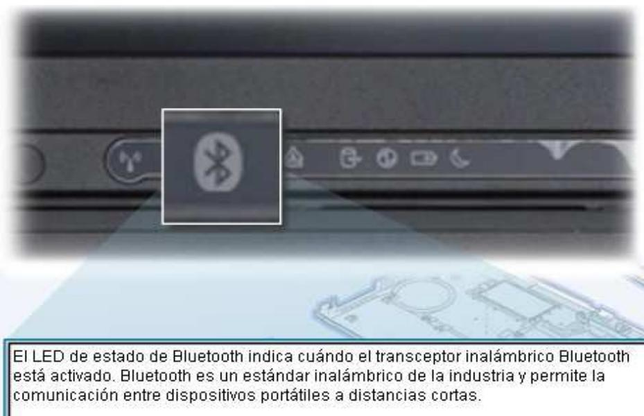
El LED de estado de Bluetooth indica cuándo el transceptor inalámbrico Bluetooth está activado. Bluetooth es un estándar inalámbrico de la industria y permite la comunicación entre dispositivos portátiles a distancias cortas.
