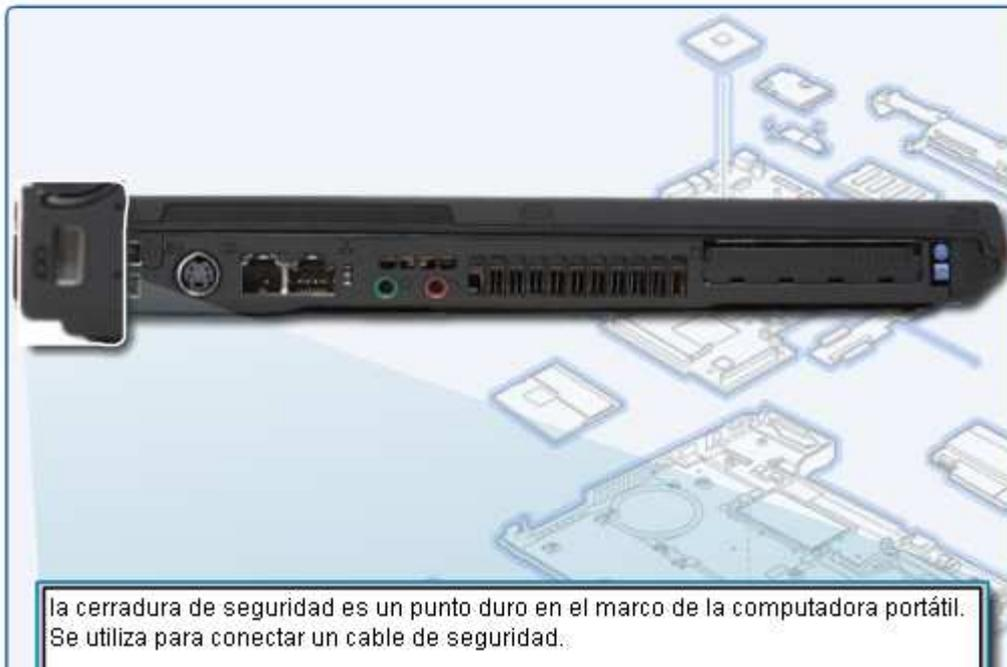
La cerradura de seguridad es un punto duro en el marco de la computadora portátil. Se utiliza para conectar un cable de seguridad.
