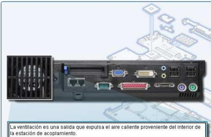
La ventilación es una salida que expulsa el aire caliente proveniente del interior de la estación de acoplamiento.
