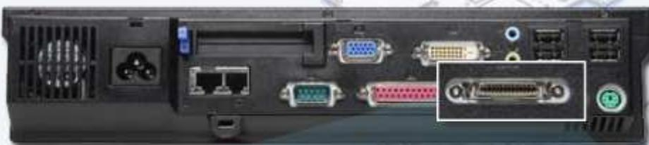
El conector de unidad de disquete externa es un socket que se utiliza para conectar una unidad de disco externa.
