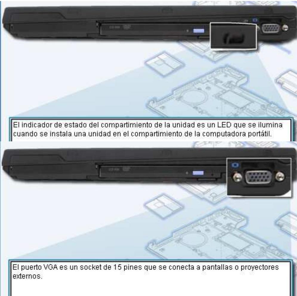
El indicador de estado del compartimiento de la unidad es un LED que se ilumina cuando se instala una unidad en el compartimiento de la computadora portátil.
