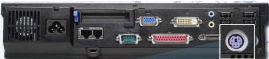
El puerto de teclado es un socket PS/2 que se utiliza para conectar un teclado externo.
