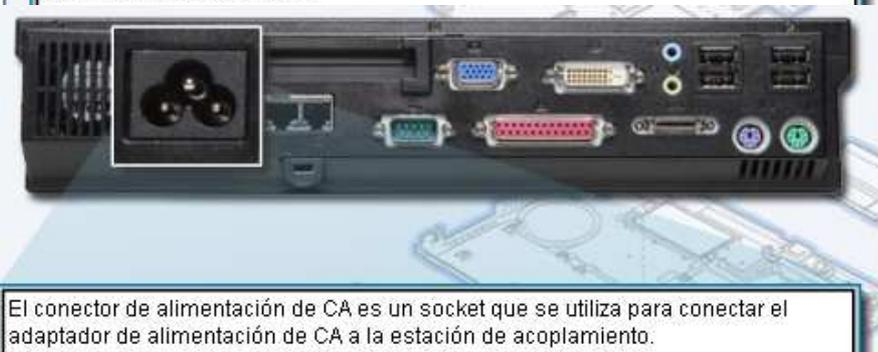
El conector de alimentación de CA es un socket que se utiliza para conectar el adaptador de alimentación de CA a la estación de acoplamiento.
