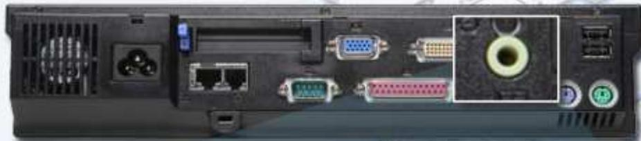
El conector para auriculares es un socket que se utiliza para conectar un dispositivo de salida de audio.
