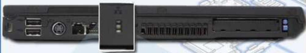
Los dos LED de red son luces que indican el estado de la conexión de red. La luz verde de enlace indica la conectividad de la red. La otra luz LED indica el tráfico desde la computadora portátil y hacia ella.
