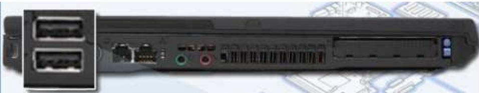
El puerto de bus serial universal (USB, Universal Serial Bus) es un socket que se utiliza para conectar uno o más dispositivos periféricos.
