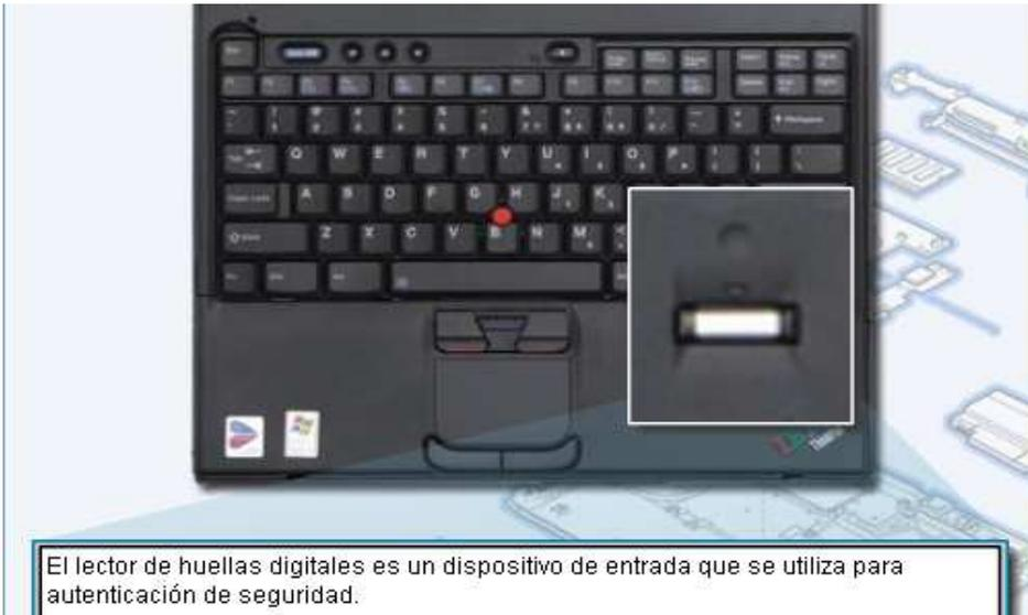
El lector de huellas digitales es un dispositivo de entrada que se utiliza para autenticación de seguridad.
