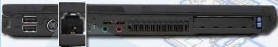
El puerto de módem RJ-11 es un dispositivo que se utiliza para conectar la computadora portátil a una línea telefónica estándar. El módem puede utilizarse para conectar la computadora a Internet, para enviar documentos por fax y para responder las llamadas entrantes.
