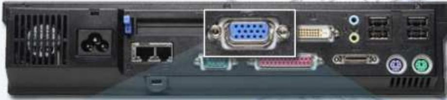
El puerto VGA es un socket de 15 pines que permite la salida a pantallas o proyectores externos.
