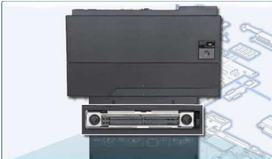
El conector de acoplamiento es un socket que se utiliza para conectar una computadora portátil a una estación de acoplamiento.
