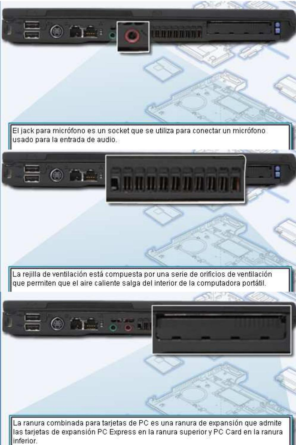
El jack para micrófono es un socket que se utiliza para conectar un micrófono, usado para la entrada de audio.
