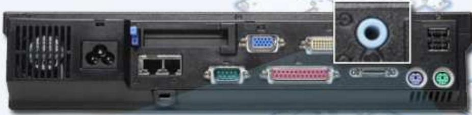
El conector de entrada de línea es un socket que se utiliza para conectar una fuente de audio.
