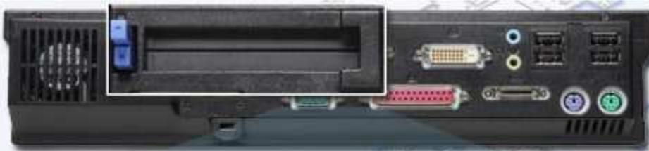
La ranura combinada para tarjetas de PC es una ranura de expansión que admite tarjetas de expansión PC Express en la ranura superior y PC Card en la ranura inferior.
