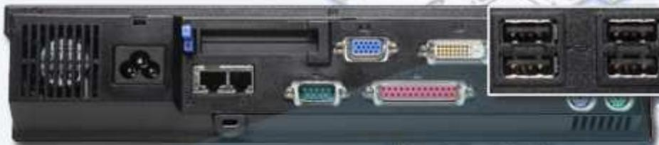
El puerto de bus serial universal (USB, Universal Serial Bus) es un socket que se utiliza para conectar uno o más dispositivos periféricos.
