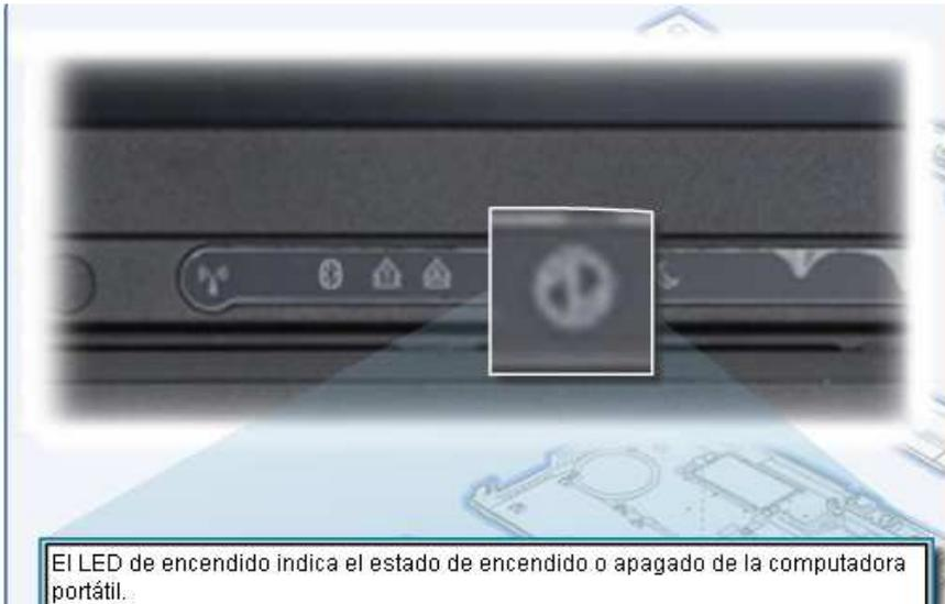
El LED de encendido indica el estado de encendido o apagado de la computadora portátil.
