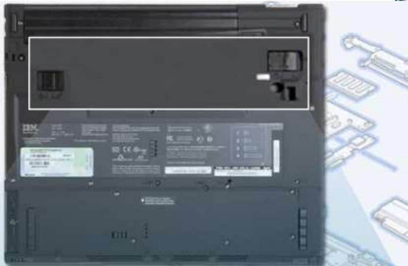
Las dos trabas de la batería son palancas que se utilizan para insertar, quitar o asegurar la batería de la computadora portátil.
