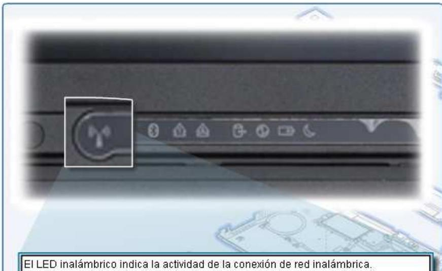
El LED inalámbrico indica la actividad de la conexión de red inalámbrica.
