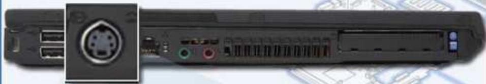
El puerto de S-video es un conector de cuatro pines, mini DIN, que se utiliza para producir señales de vídeo en un dispositivo compatible. S-video separa las partes de brillo y color de una señal de vídeo.
