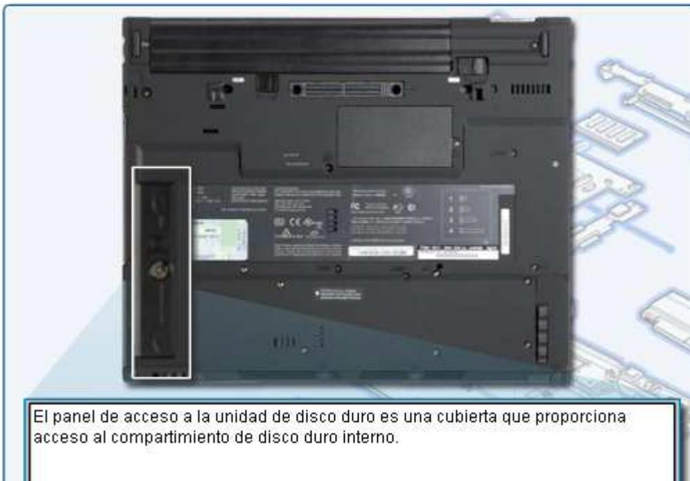
El panel de acceso a la unidad de disco duro es una cubierta que proporciona acceso al compartimiento de disco duro interno.
