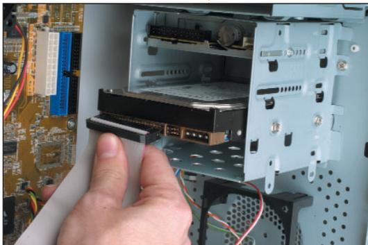
**2** El extremo de color azul es el que debe conectarse en el zócalo IDE1 (del mismo color) de la placa base. Para orientar el cable correctamente conviene fijarse en las etiquetas serigrafiadas sobre la placa base, junto a los conectores. En uno de los extremos de cada conector IDE aparece una marca con el número 1, que deberá coincidir con el lado del cable plano IDE de color rojo o negro.
