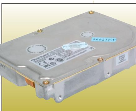
**1** Cualquier disco duro se compone de dos partes bien diferenciadas, por un lado está toda la parte mecánica (brazos, ejes, cabezales, etc.) y por el otro, la parte lógica, un pequeño circuito electrónico que gobierna el funcionamiento de la parte mecánica y actúa de interfaz con el bus de datos.
