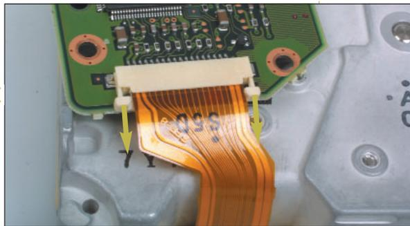
**6** Una vez se han separado las dos partes principales del disco duro, puede retirarse la parte lógica estropeada y colocar en su lugar la que sí funciona, que previamente se ha desmontado del disco duro "sacrificado". Hay que extremar la precaución a la hora de manipular los cables de tipo cinta, pues se estropean con facilidad y esto podría significar la pérdida irreparable de los dos discos.
