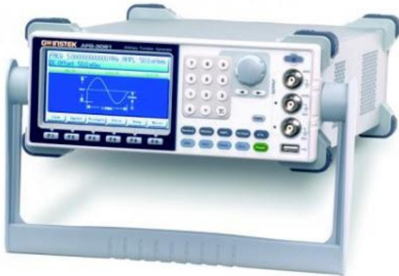
Es un dispositivo electrónico de laboratorio que genera patrones de señales periódicas o no periódicas tanto analógicas como digitales. Se emplea normalmente en el diseño, prueba y reparación de dispositivos electrónicos
