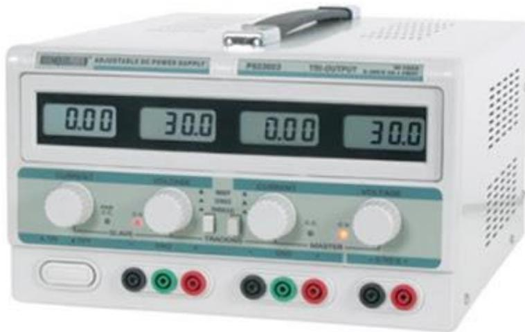
Es en esencia un generador de tensión continua (Voltaje), con limitador de corriente (Amperios), ambos regulables, y debidamente estabilizada y filtrada.
