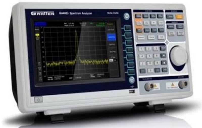
Un analizador de espectro es un equipo de medición electrónica que permite visualizar en una pantalla las componentes espectrales en un espectro de frecuencias de las señales presentes en la entrada, pudiendo ser ésta cualquier tipo de ondas eléctricas, acústicas u ópticas.
