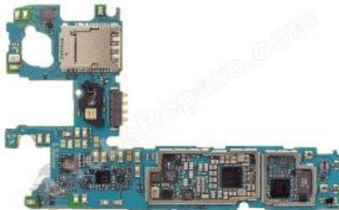
2-Sumergir la placa en la cubeta con el **alcohol Isopropilico**.
