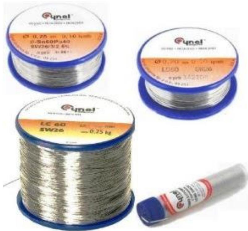
Las aleaciones más usadas es **Sn/Pb 60/40**, (60% estaño y 40% plomo) con alma de resina. Muy cercana a la del punto eutéctico\* proporciona una transición de sólido a líquido lo suficientemente rápida. Empieza a fundir a 183°C y está totalmente fundida a 188°C.
