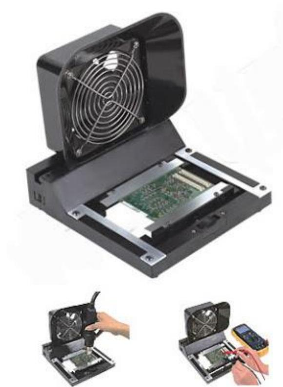
La **estación de aire caliente** se hace imprescindible, ya que la electrónica que vamos a manejar es casi en su totalidad **SMD (Componente de Montaje Superficial)** son muy diminutos como para aplicar el soldador manual. En su lugar se utiliza aire caliente para su **soldadura y desoldadura**.
