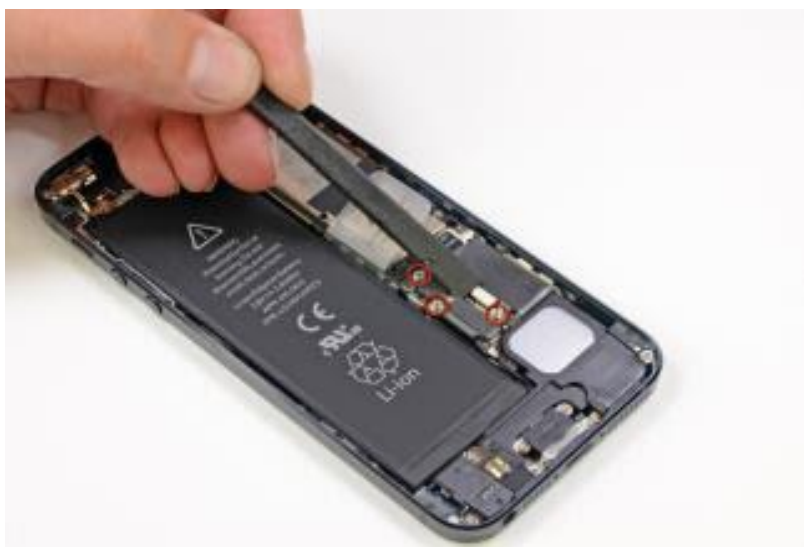
desmontar conector de la batería
