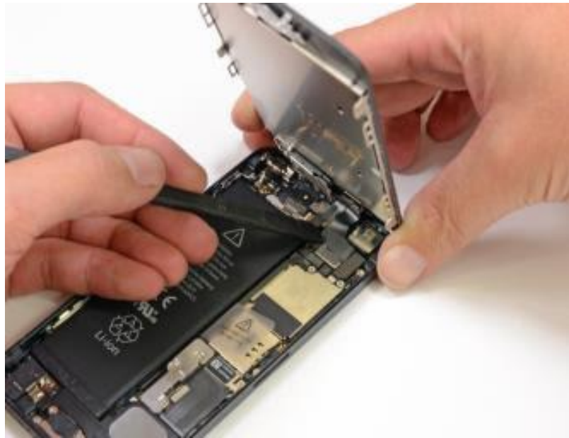
desmontar flex de la batería iphone
