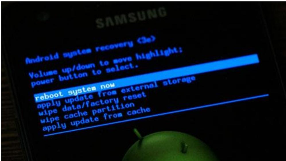
Si el dispositivo está congelado que no se apaga, podemos forzar su apagado o su reinicio, presionando simultáneamente tecla power y volumen- .
