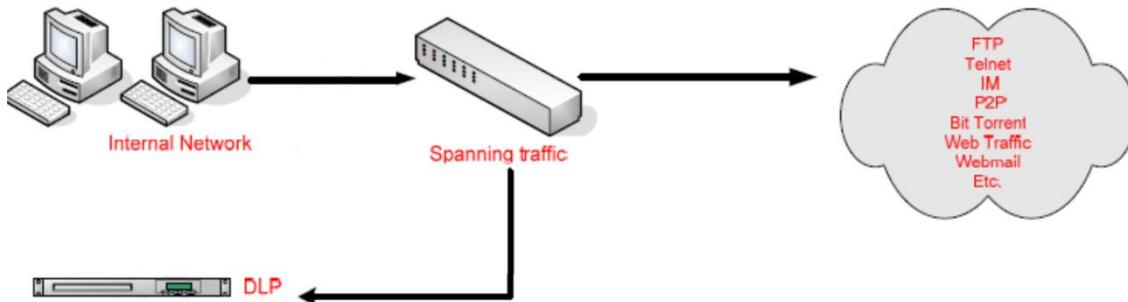
Como se muestra arriba, todo el tráfico que de la red interna a través de cualquiera de los canales comunes se reflejará a DLP para la inspección.
