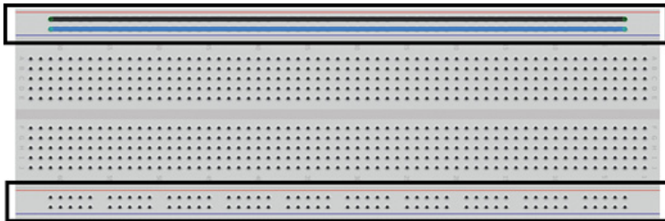
Figura 2.18. Protoboard con dos zonas de alimentación
