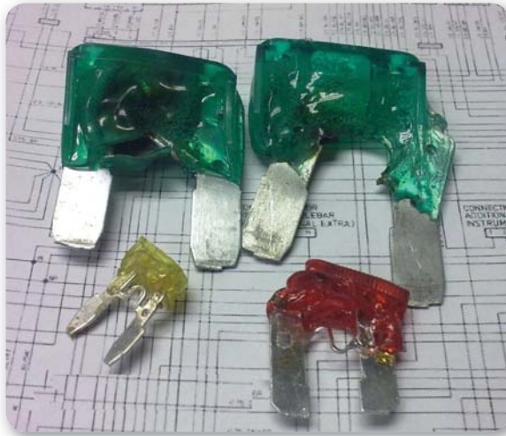
Figura 5. Nunca debemos puentear el fusible con un alambre, ya que podemos causar daños aún más graves.
