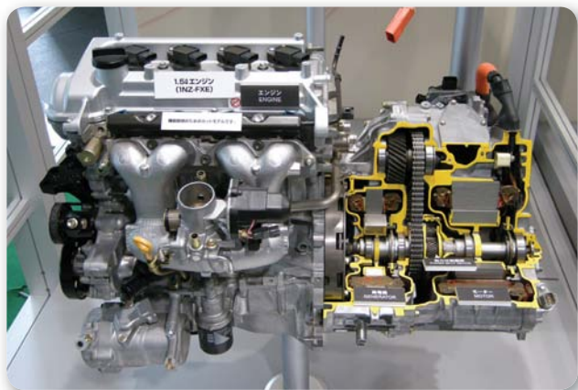
Figura 5. Motor híbrido de Toyota, modelo 1NZ. Se observa el conjunto de motor térmico, generador y motor eléctrico. A la izquierda el motor térmico, y a la derecha motor eléctrico.
