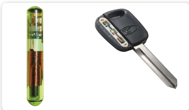
Figura 12. Llave con chip transponder en el cabezal.
