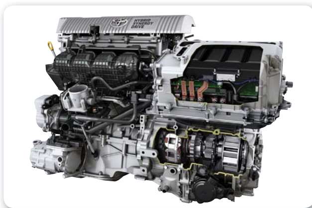
Figura 6. El motor Hybrid Synergy Drive (HSD) , de Toyota, integra un sistema de control electrónico para ahorro de combustible y control de tracción.
