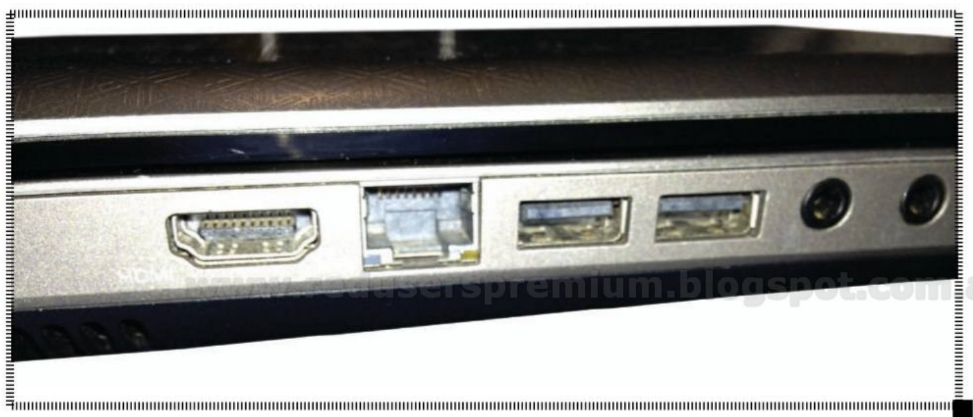
Entrada de red de una notebook a través de la interfaz Ethernet, utilizada para conexiones de redes privadas e Internet.
