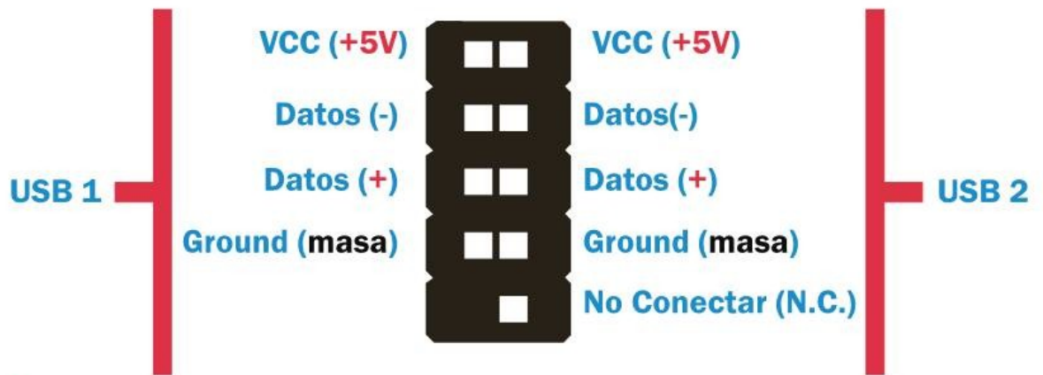
Identificación de color y descripción de cada conductor presente en el cable USB. A su vez, se muestra la distribución de cada pin en un zócalo de puerto USB.
