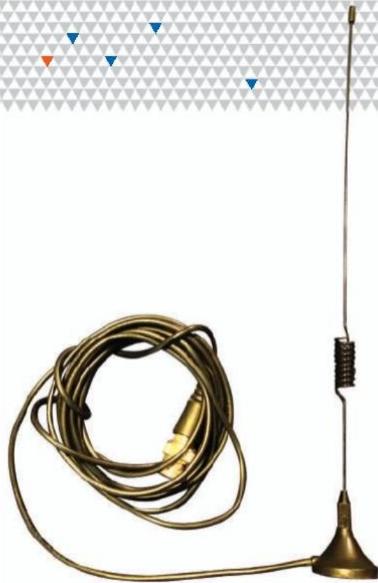
▲ Antena para enrutamiento inalámbrico de una red. Posee una interfaz con ficha BNC y es capaz de transferir frecuencias de radio.
