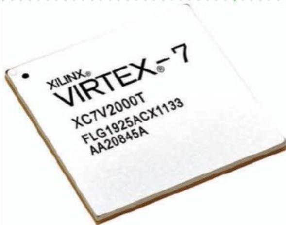
El FPGA se basa en una matriz de compuertas que se comunican entre sí mediante canales de conexiones verticales y horizontales.
