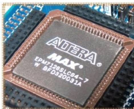
**Los dispositivos lógicos programables complejos (en inglés, Complex Programmable Logic Device, o CPLD) se programan por hardware y suplen miles de compuertas lógicas.**
