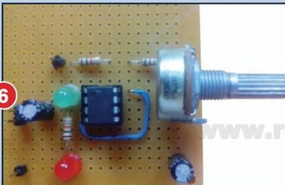
Se puede apreciar la plaqueta terminada. En esta plaqueta, se realizaron puentes con alambre envainado, para evitar interferencias.
