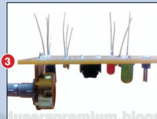
Recordemos que, en el momento de soldar, es fundamental tener un orden sobre los componentes utilizados. De esta manera, conviene soldar los componentes de menor a mayor tamaño.
