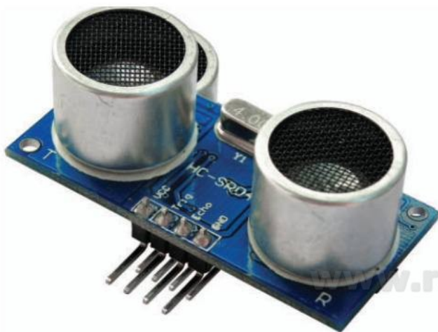
▲ Sensor de distancia por ultrasonido que mide distancias de 2 cm a 3 m y requiere un pin I/O para conectarlo a un microcontrolador.
