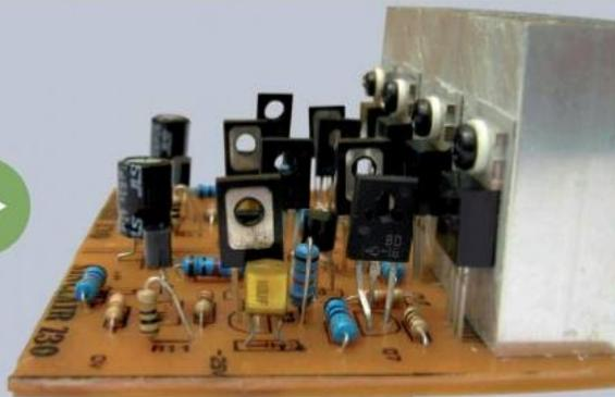
**Los transistores de potencia vienen preparados para ser acoplados a disipadores de calor y evitar quemarse debido a la gran temperatura que levantan.**
