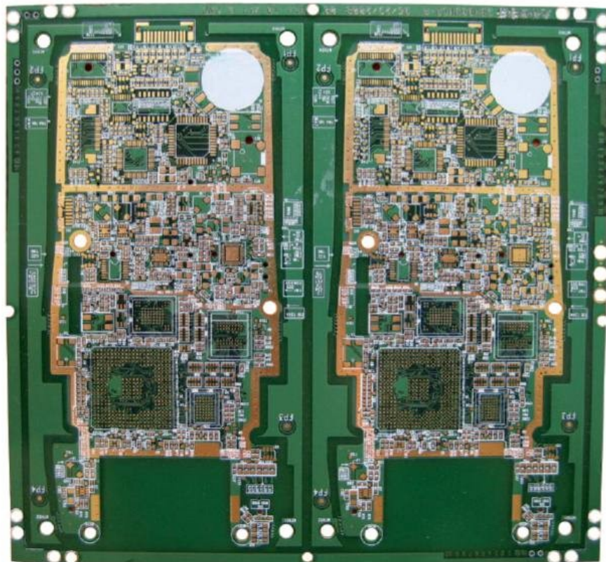
Circuito impreso multicapa. Se utiliza solo en equipos que requieren gran cantidad de componentes e interconexión de espacios reducidos.
