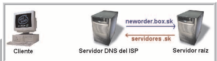
Fig 8.- El servidor de nuestro ISP consulta con el servidor raíz, y éste le da la lista de servidores del TLD .sk
