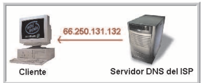
Fig 11.- El servidor de nuestro ISP nos responde con un datagrama UDP.
