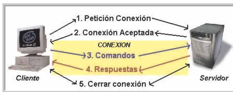
Fig 1.- Esquema del protocolo TCP/IP, orientado a conexión
