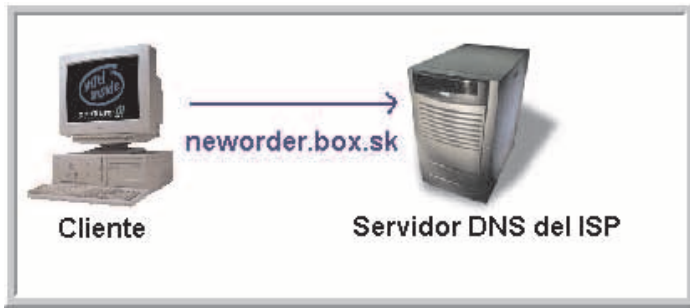
Fig 6.- Nuestra máquina envía un datagrama UDP al servidor DNS de nuestro ISP solicitando la traducción del nombre.
