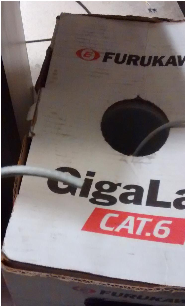
Con un **alicate**, corto un pedazo del tamaño que quiera el cable. Hay que cortarlo un **poco más largo** de lo normal por el simple hecho de poder equivocarnos, del hecho que siempre hay que dejar un poco de cable sobrante y que cuando hagamos los conectores se achicará unos poquitos centímetros.
