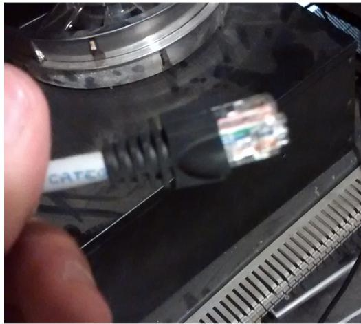
Sacamos el cable y **hacemos** el otro **extremo**. Cuando quede entero, podemos probarlo en algún dispositivo o podemos hacerlo con el **tester de cables de red**.
