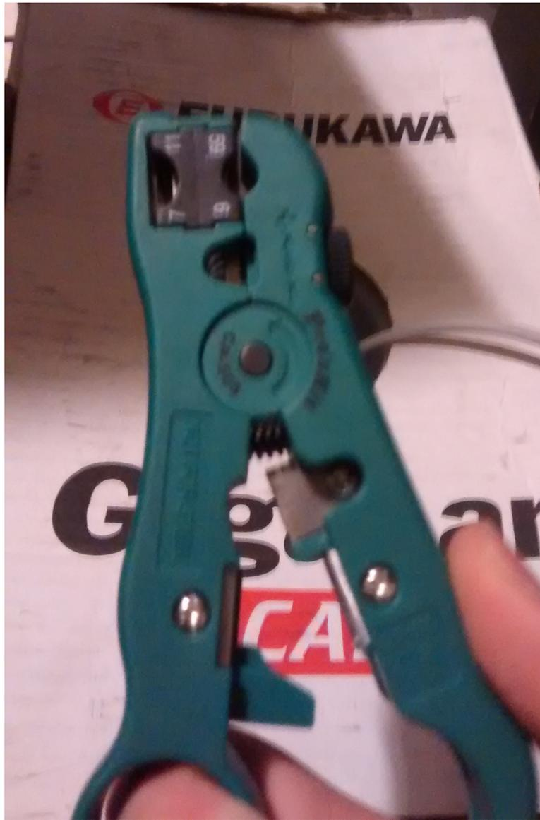
Aquí tenemos nuestro hermoso próximo conector. Necesitamos **pelarlo**. Yo en particular tengo una herramienta que me facilita el **cortado del aislante** sin dañar los cables internos, pero si están haciendo algo casero y no tienen las necesidades de ésta, usen un **cutter** que funciona de la misma manera. Háganlo cuidadosamente.
