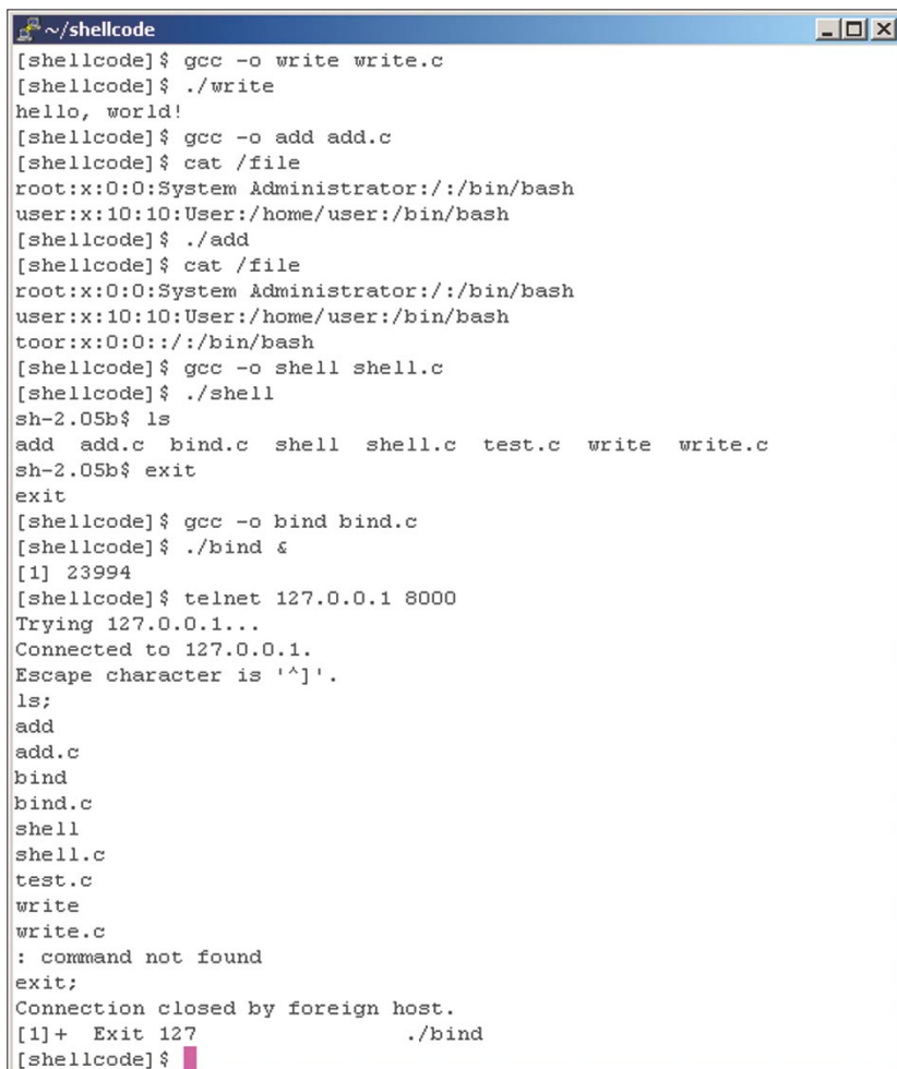
Figura 2. Compilación y acción de los programas write , add , shell y bind
