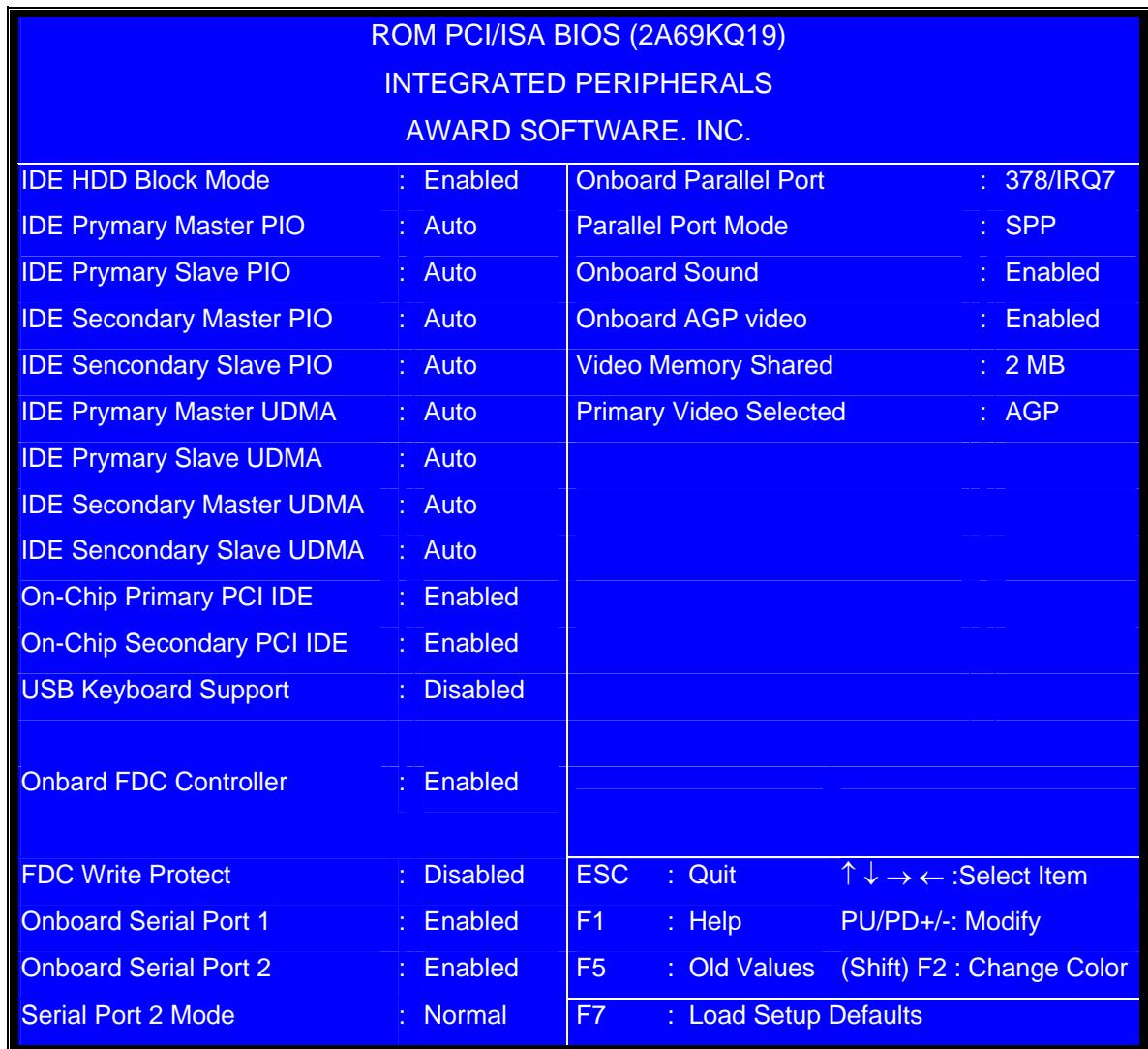
Figura 11.8: Submenú de configuración de Periféricos Integrados
