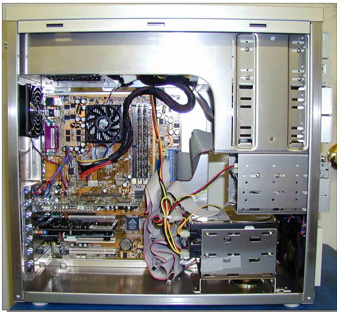
Figura 3.10: Vista interior del gabinete de una PC.
