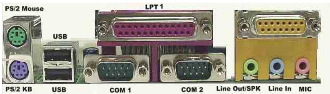
Figura 3.12 Detalle del panel trasero
