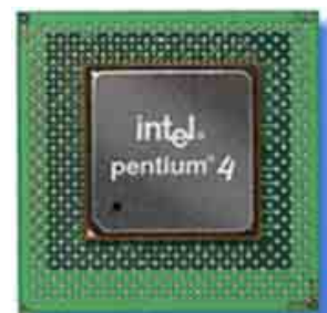
Figura 3.13 Microprocesador Intel Pentium 4
