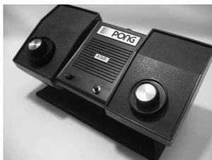
**Figura 7.2:** El hardware de Atari Pong estaba especialmente pensado para el manejo de las dos palas que forman el juego.
