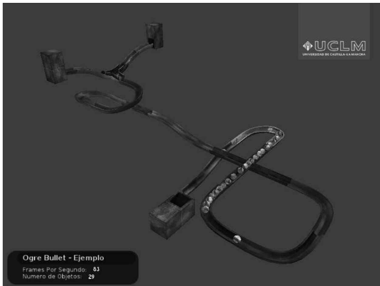
Figura 6.30: Ejemplo de detección de colisiones empleando colectores de contactos.
