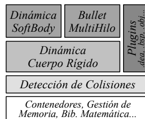
Figura 6.19: Esquema de los principales módulos funcionales de Bullet.
