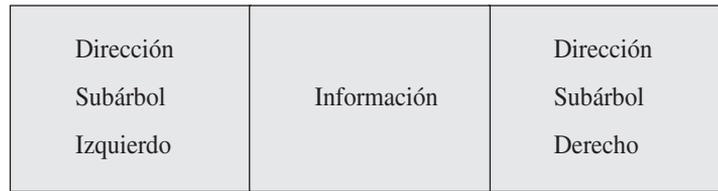
**FIGURA 7.2** Estructura de un nodo de un árbol binario
