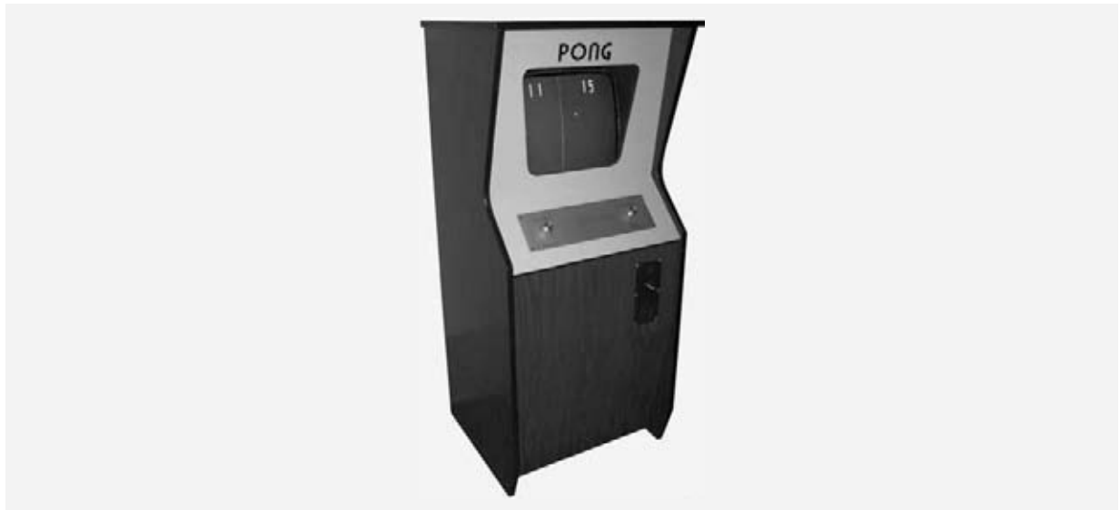
Figura 23.2 | La máquina tragamonedas de Pong de Atari entró en producción comercial en noviembre de 1972, vendiendo un total de 38,000 máquinas. El juego fue diseñado completamente en circuitos TTL, sin utilizar CPU ni software de código de juego. Su “código” se implementó utilizando chips de “compuerta” simples, temporizadores y chips contadores. Este juego simple, divertido y adictivo fue la piedra angular de lo que se convirtió en la industria de los videojuegos. (Videojuego clásico PONG®, cortesía de Atari Interactive, Inc. © 2007 Atari Interactive, Inc. Todos los derechos reservados. Uso permitido).
