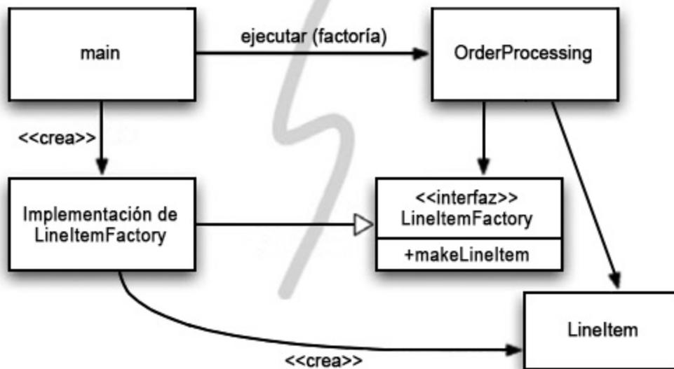
Figura 11.2. Separación de la construcción con una factoría.
