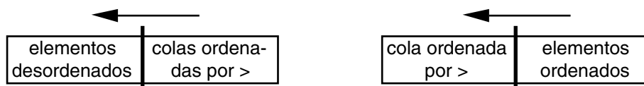
Fig. 5.44: heapsort: construcción de la cola (izq.) y ordenación de los elementos (der.); la flecha indica el sentido del desplazamiento de la frontera entre las partes del vector.
