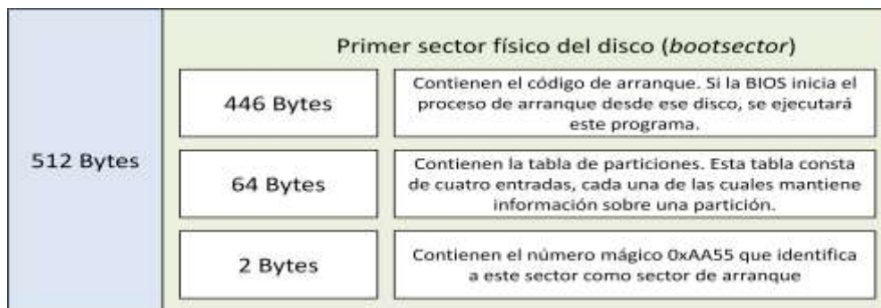
Figura 2.1: Estructura del MBR
