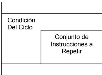
Para representar un ciclo sencillamente en la esquina superior izquierda del bloque correspondiente colocamos la condición y dentro del bloque colocamos las instrucciones o acciones que se debe repetir y que a su vez, por supuesto, dependen de la condición.
