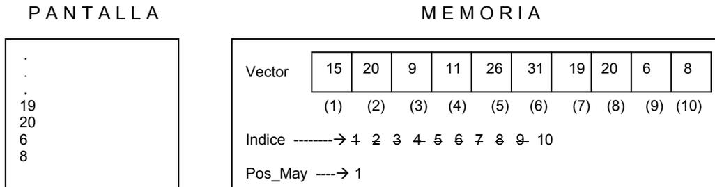
Luego continúa realizando un ciclo *Para* utilizando la variable *Indice* que va a tomar valores desde 2 hasta 10 y que va a servir como referencia para compara desde el elemento *Sub 2* hasta el elemento *Sub 10* del vector con el primer elemento.
