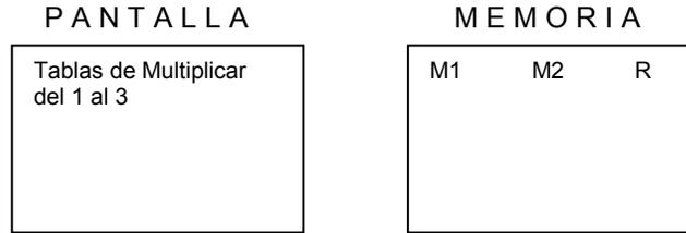
El ciclo externo involucra una variable  $M1$  que va a tomar valores comenzando en 1 y terminando en 3 (inclusive) de 1 en 1. Así mismo el ciclo interno incluye una variable  $M2$  que va a tomar valores comenzando en 1 y terminando en 10 (inclusive) de 1 en 1. Dentro del ciclo mas interno ejecutará el resultado de multiplicar  $M1$  por  $M2$  y lo almacenará en la variable  $R$  mostrando todo en pantalla.
