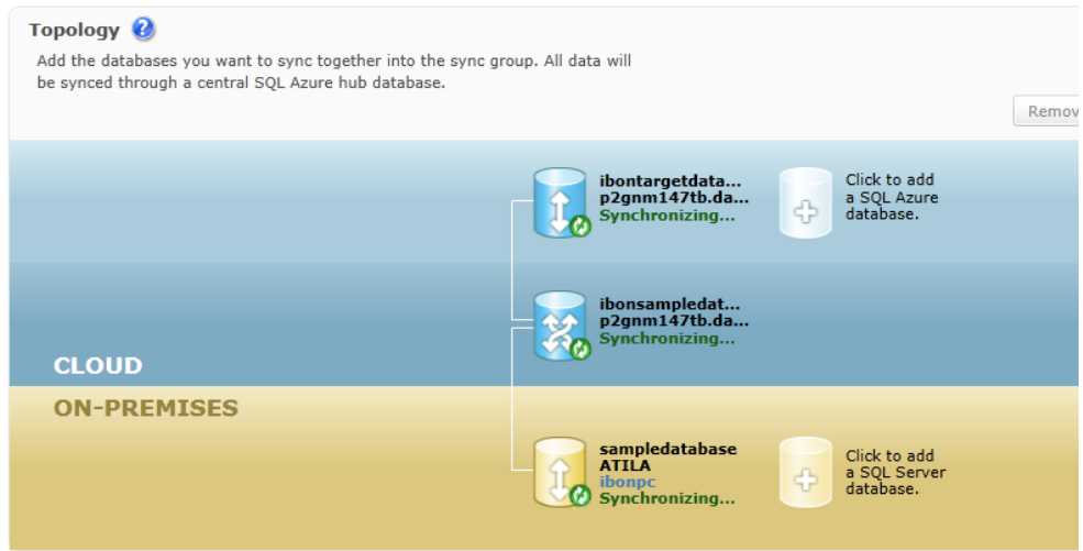
Figura I.72.- Topología del grupo de sincronización
