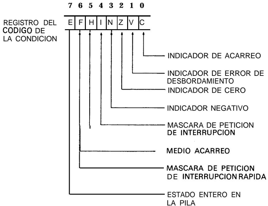
Figura 4.2. Indicadores del microprocesador 6809
