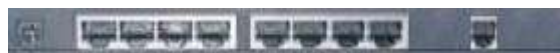
Panel trasero de un router con 8 puertos RJ45 para los equipos de la LAN. A la derecha conector RJ9 para conexión a red telefónica
