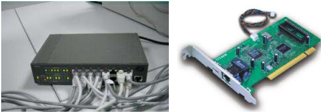
Figura 22. a) Concentrador de cableado, Hub. b) Tarjeta de red Ethernet instalada en los equipos.
