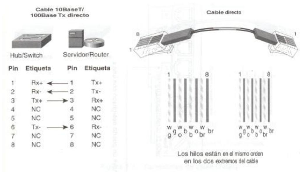
**Figura 2.5** Conexiones de cable directo.
