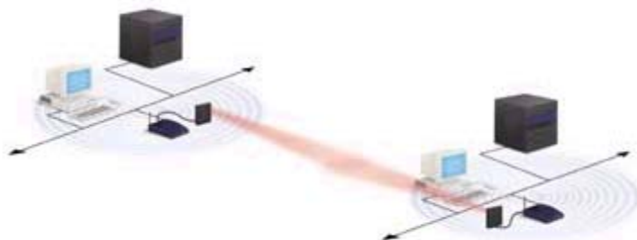
Figura 7 - Interconexión de LAN mediante antenas direccionales
