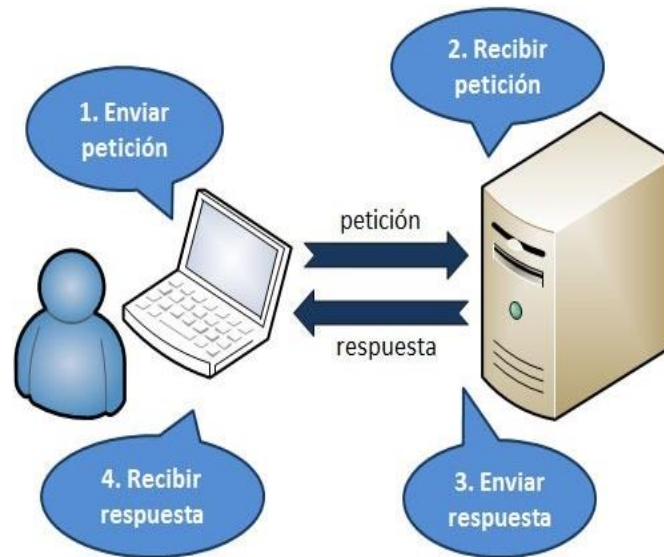
Figura 2.4 Función de un servidor HTTP (Fuente: http://www.edu4java.com/es/web/web30.html )
