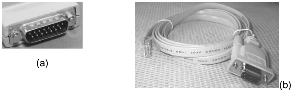
FIGURA 9. (a) Conector AUI (DB-15). (b) Cable de consola (RJ-45 a DB-9).
