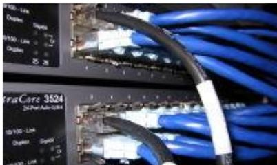
Los conmutadores poseen la capacidad de aprender y almacenar las direcciones de red de nivel 2 (direcciones MAC) de los dispositivos alcanzables a través de cada uno de sus puertos. Por ejemplo, un equipo conectado directamente a un puerto de un conmutador provoca que el conmutador almacene su dirección MAC. Esto permite que, a diferencia de los concentradores o hubs, la información dirigida a un
