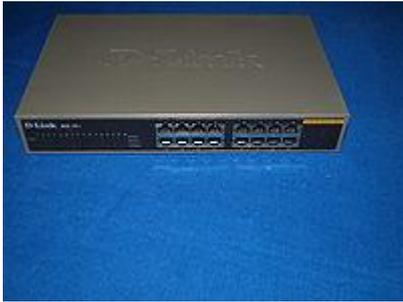
Un conmutador o switch es un dispositivo digital de lógica de interconexión de redes de computadores que opera en la capa 2 (nivel de enlace de datos) del modelo OSI. Su función es interconectar dos o más segmentos de red, de manera similar a los puentes (bridges), pasando datos de un segmento a otro de acuerdo con la dirección MAC de destino
