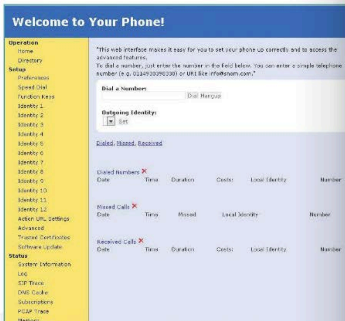
Interfaz web de un teléfono IP Snom, que permite realizar llamadas en forma remota, así como también visualizar la libreta de contactos.
