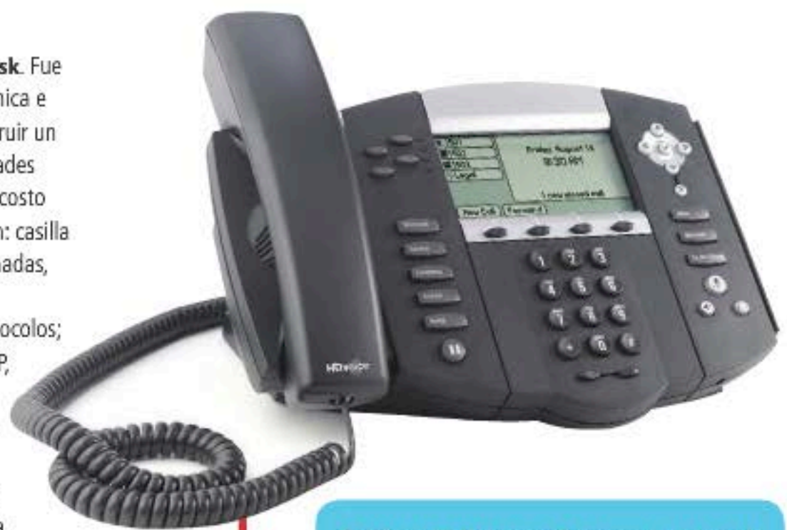
Teléfono IP Polycom. Se conecta a la red Ethernet mediante un conector RJ45.
