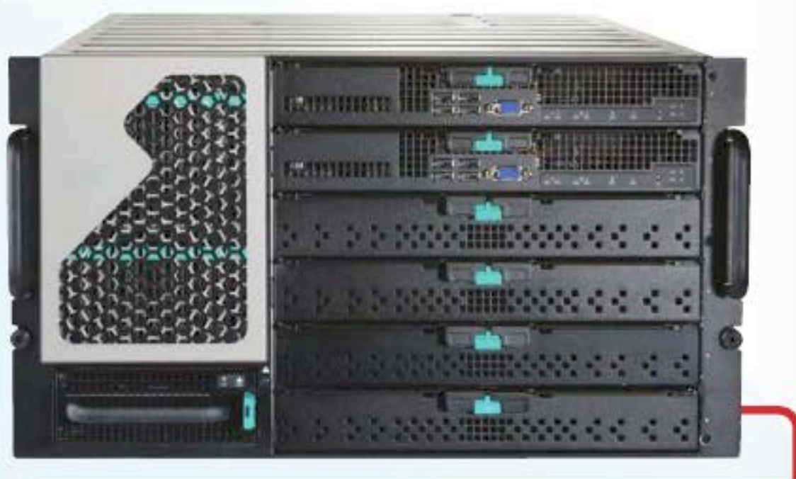
En esta imagen vemos un ejemplo de servidor, se trata de un SGI Origin 400.
