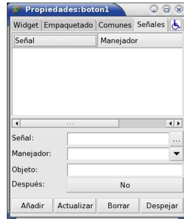
Una vez en ella hacemos click en los puntos suspensivos (...) a la derecha del campo señal para elegir el tipo de señal. Nos aparecerá entonces una larga lista de señales soportadas por ese control. Primero tendremos las señales específicas de ese control (GtkButton en este caso), luego las señales del contenedor del control y por último las genéricas a todos los controles GTK+.
